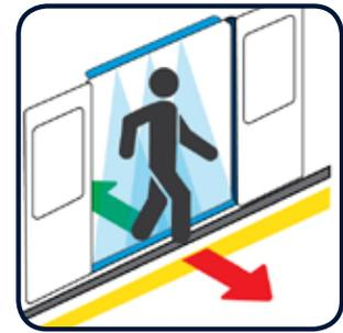
La largeur complète de la porte est couverte par les capteurs qui sont installés directement sur le seuil.
