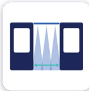
La largeur complète de la porte est couverte par les capteurs qui sont installés directement sur le seuil.
