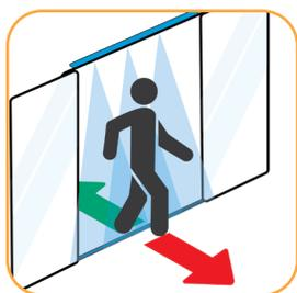
La largeur complète de la porte est couverte par les capteurs.
